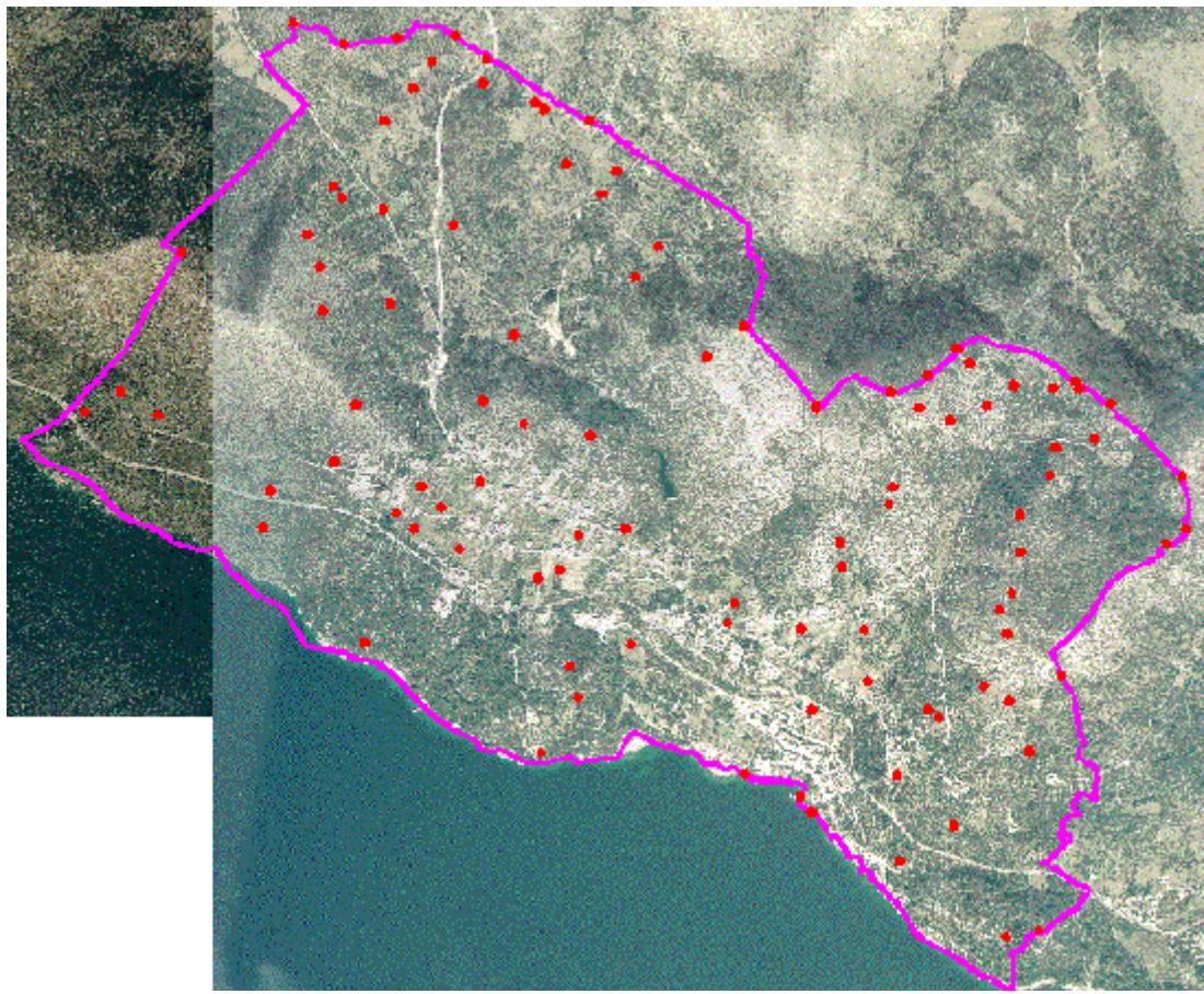
Slika 4. Raspored identičnih točaka za izmjeru
