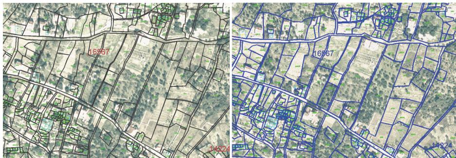
Slika 3.3 Nehomogenizirani (lijevo) i homogenizirani (desno) katastarski plan
