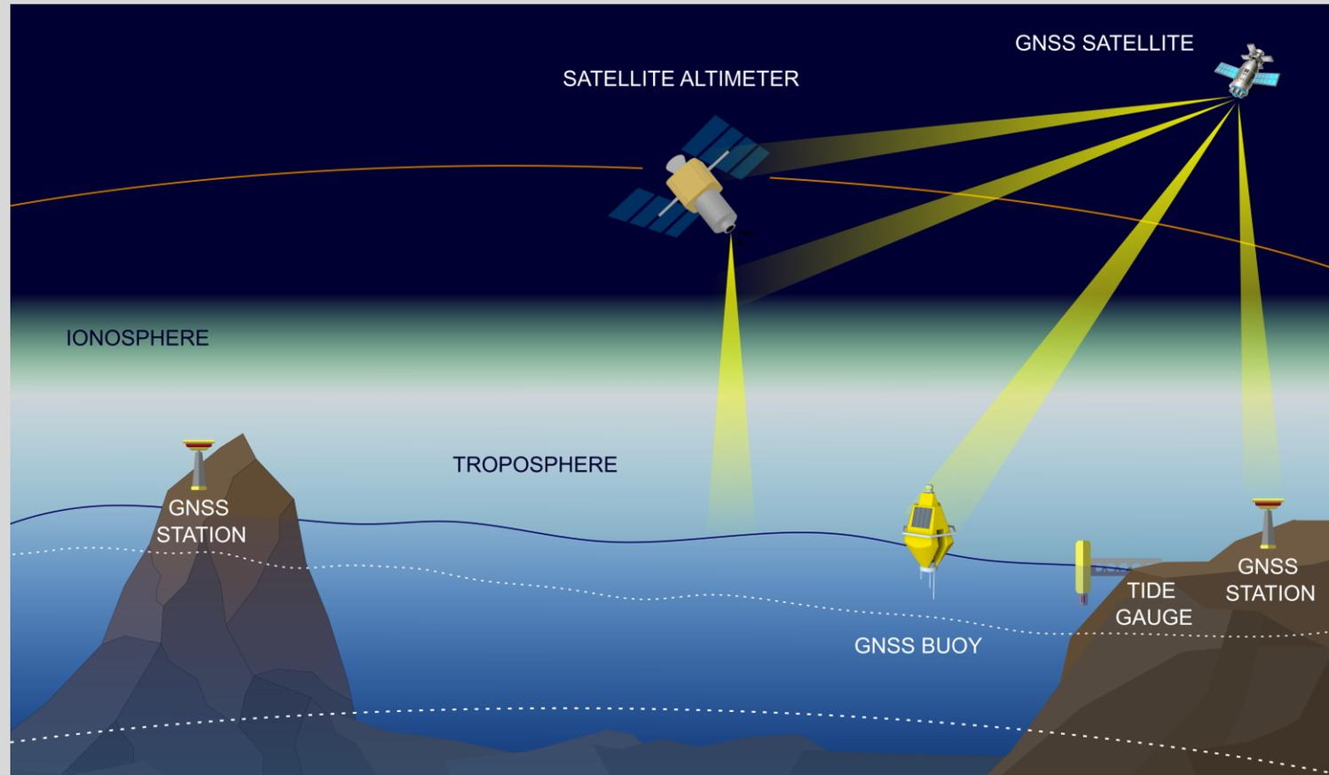
Dostupne tehnologije za određivanje razine mora i vertikalnog pomaka Zemlje
