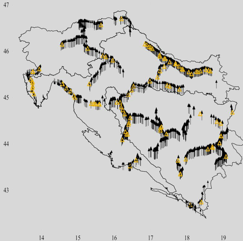
Referentna ploha za visine **na kopnu** – najčešće realizirana nivelmanskom mrežom, alternativno plohom geoida
