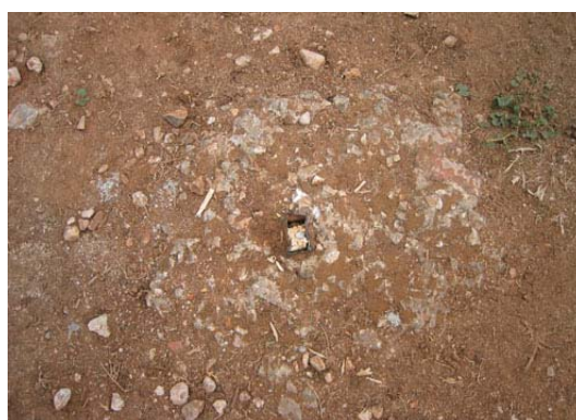
Slika 35. Primjer stabilizacije točke
