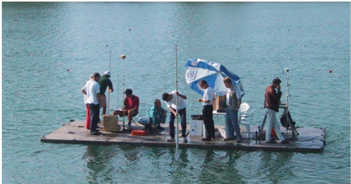
Slika 4.5.: kontrolno mjerjenje dubina mjernim letvama
