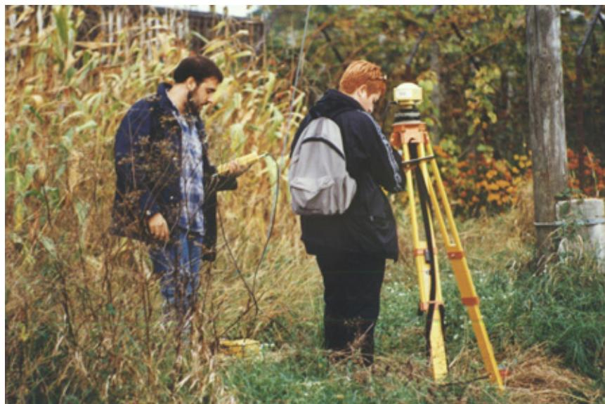
Slika 4. Pravovremeno treba uključiti GPS, ali i ucrtati zaklanjanje.
